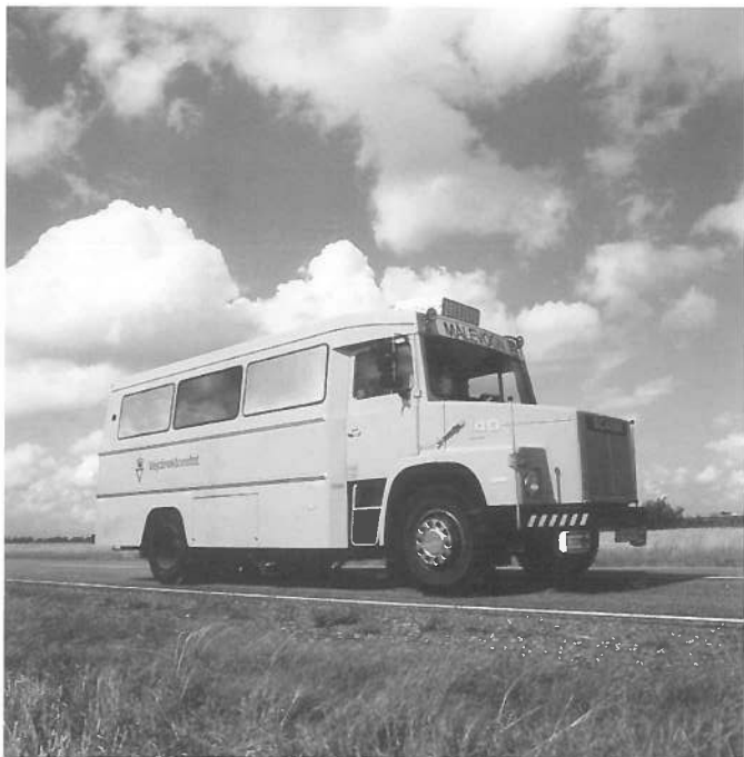
Fig. 9. Stradograf til måling af vejens friktion. Målingen sker på to fritløbende, skråtstillede hjul. Den viste målebil fungerede i perioden 1972-1997. I løbet af de 25 år blev der målt ca. 4.000 km vej om året. Foto: Vejdirektoratet.
