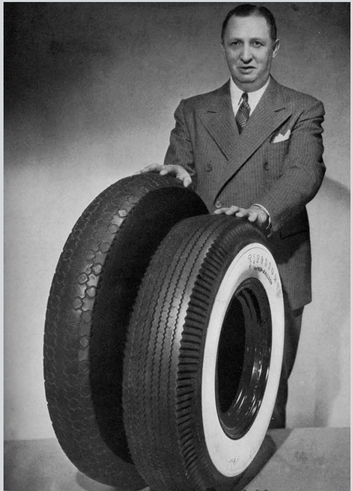
Fig. 11. Det var hjulenes høje tryk på 7-8 atm., som betød at de let kunne punktere som en ballon. I 1923 introducerede Firestone det første lavtryksdæk, som ses til venstre i billedet, og efter få år kørte alle personbiler på denne type dæk. Hjulet var samtidig meget skånsomt for vejene, og udskød vejfolkenes problemer med nedslidningen fra de mange biler. Det varede dog ti år før det også blev muligt at fremstille lavtryksdæk til lastbiler. Foto: Firestone.
