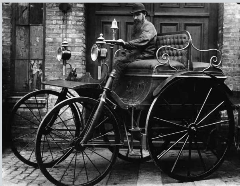
Fig. 4. Visionen om det hesteløse køretøj levede hos teknisk interesserede. Herhjemme byggede fabrikant Hammel Danmarks første bil omkring 1888 som en af verdens 4-5 første biler. Bilen blev ikke sat i produktion, men fik betydning ved at vise, at biler kunne fremstilles. Foto: Danmarks Tekniske Museum.
