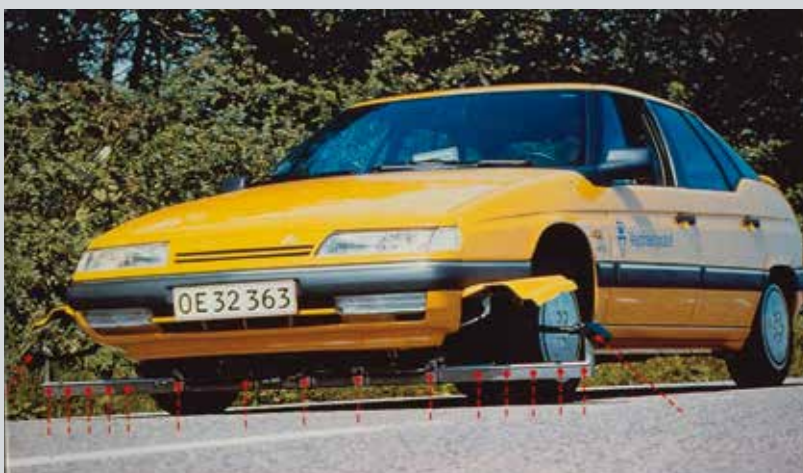
Profilografen, der i 1980'erne blev udviklet af Statens Vejlaboratorium i samarbejde med en tidligere ansat Niels Grønsvov, måler med et antal laserere monteret på køretøjet vejbelægningsens tilstand, bl.a. sporkøring, jævnhed mv. Resultaterne bruges i planlægningen af vejenes vedligeholdelse. Profilografen anvendes af Vejdirektoratet og flere kommuner og er et eksempel på et avanceret måleudstyr, som alle vejforvaltninger har nytte af.
