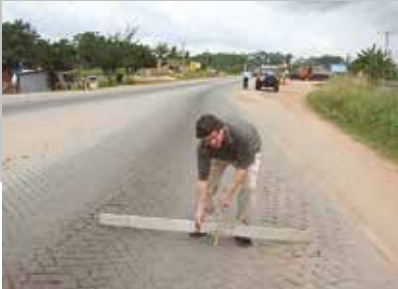
Den danskbyggede vej fik også sporkøring, hvor tunge køretøjer efterhånden skaber dybe spor i vejen. Foto NIRAS 2008.
