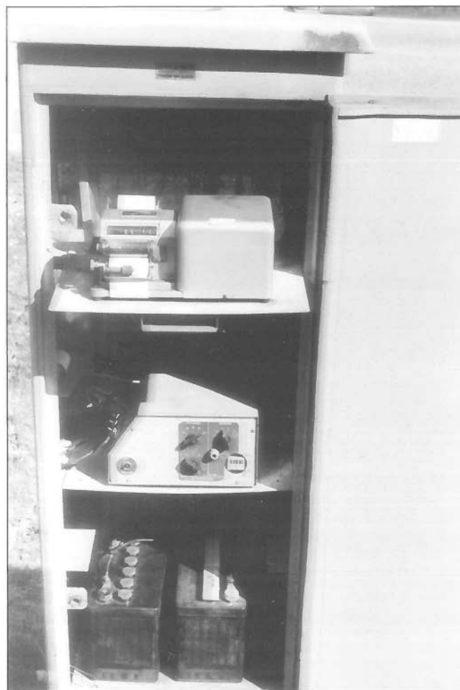
Fig. 5. DEA- og IVO-apparaterne med strømforsyning i et tælleskab.
