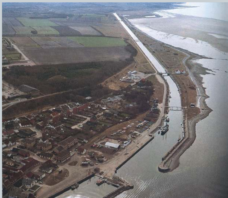
Fig. 4. Frederik den VII's Kanal fotograferet fra Løgstør mod Lendrup. I forgrunden ses østre svajebassin. Dernæst ses drejebroen, der fører over til den hvide kanalføgebolig. Kanalen knækker ca. 2/3 mod Lendrup, og i det fjerne kan man ane vestre svajebassin.
