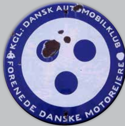
Færdselstavlen for indkørsel forbudt fra 1919 viser tydelige skader. Datidens tavler blev fremstillet af stålplader belagt med emalje, der som glasmateriale var meget sårbart over for slag. MARTIN MEINERS.
